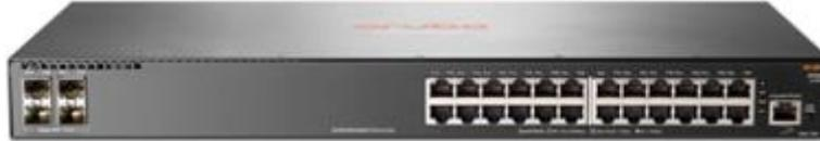
Le funzionalità Layer 3 includono fino a 256 Static IP routing e 10.000 rotte con il protocollo RIPv1, RIPv2 e RIPng. Viene supportato il protocollo OSPF su singola area e fino a 8 interfacce di routing. Supporto Policy-based routing.
