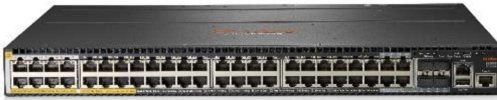
Il Virtual Chassis dei Aruba 2930M viene gestita tramite i moduli di stack Hardware.
